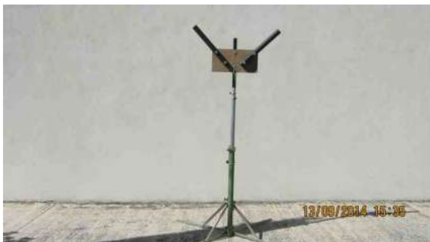
VUE DU SUPPORT EN « V » EN HAUT DU MAT ALUMINIUM REPLIE
