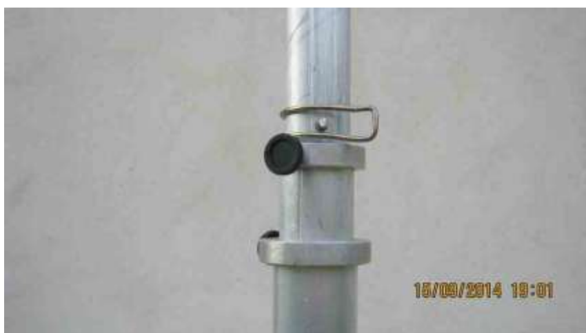
VUE D'UNE GOUPILLE DE VERROUILLAGE DU MAT TELESCOPIQUE
